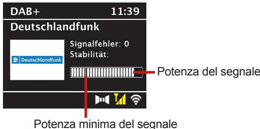
**i** I trasmittitori il cui livello è inferiore alla potenza minima del segnale richiesta non trasmettono un segnale sufficiente. Se necessario, allinea l'antenna come descritto al punto 6.2.
