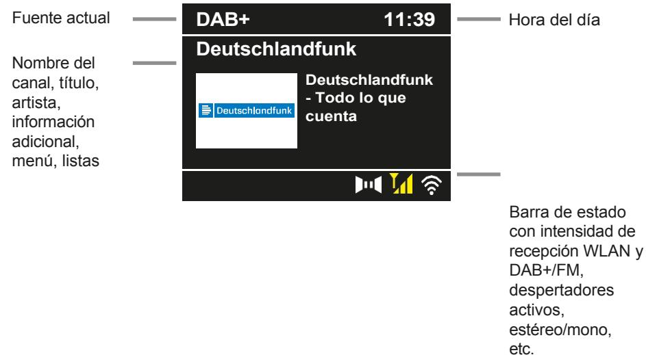
Barra de estado con intensidad de recepción WLAN y DAB+/FM, despertadores activos, estéreo/mono, etc.
