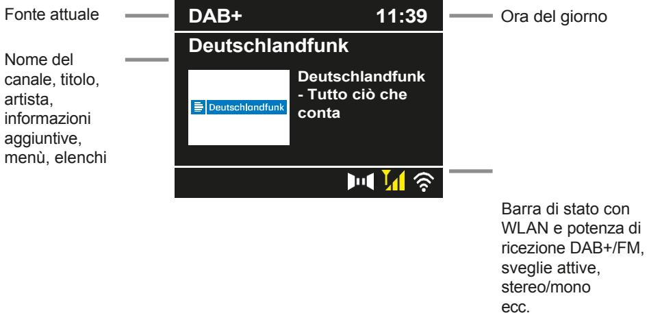
**i** La visualizzazione può variare a seconda della funzione/sorgente selezionata. Segui le istruzioni visualizzate sul display.
