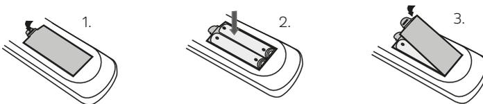
2. Legen Sie 2x AAA 1,5V Batterien unter Berücksichtigung der Polung in die Fernbedienung ein. Die Ausrichtung ist im Batteriefach abgebildet.
