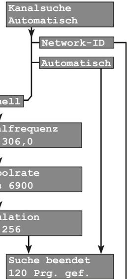
Der Suchlauf ist beendet und die Anzahl der gefundenen Radioprogramme wird angezeigt.
