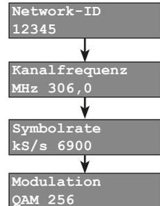
Der Suchlauf ist beendet wenn die Anzahl der gefundenen Radioprogramme wird angezeigt wird.
